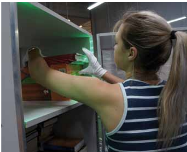
Każda półka na stanowisku kompletacyjnym B2B wyposażona jest w specjalne fotokomórki z LED-owym paskiem, który podświetla półkę, na jaką ma trafić zeskanowana książka, lub oznacza błędnie wybraną lokalizację, kiedy operator odłoży książkę na nieodpowiednią półkę (fot. OSDW AZYMUT)
